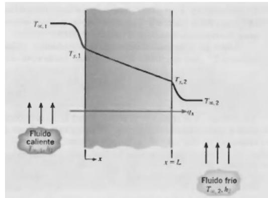
Que separa los fluidos caliente y frio a temperaturas  $T_{\infty 1}$  y  $T_{\infty 2}$ , respectivamente.
