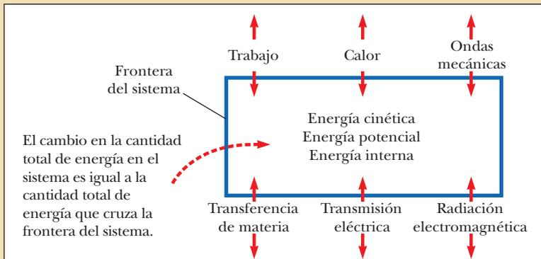
**Sistema no aislado (energía).** El enunciado más general que describe el comportamiento de un sistema no aislado es la **ecuación de conservación de energía**:
