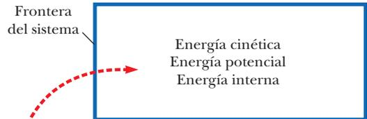
La cantidad total de energía en el sistema es constante. La energía se transforma entre los tres tipos posibles.
