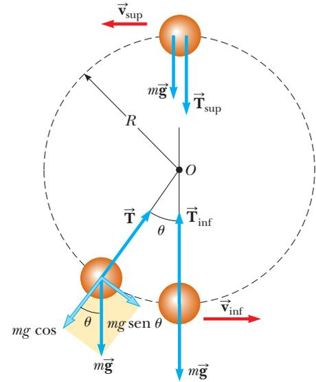
**Figura 6.9** (Ejemplo 6.6) Fuerzas que actúan sobre una esfera de masa  $m$  conectada a una cuerda de longitud  $R$  y que gira en un círculo vertical con centro en  $O$ . Las fuerzas que actúan sobre la esfera se muestran cuando la esfera está en la parte superior e inferior del círculo y en una posición arbitraria.
