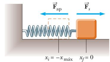
**Figura 7.10** Un bloque se traslada desde  $x_i = -x_{\text{máx}}$  a  $x_f = 0$  sobre una superficie sin fricción conforme se aplica una fuerza  $\vec{\mathbf{F}}_{\text{ap}}$  al bloque. Si el proceso se realiza muy lentamente, la fuerza aplicada es igual en magnitud y opuesta en dirección a la fuerza del resorte en todo momento.
