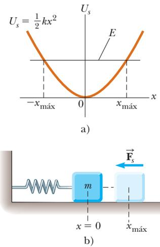
**Figura 7.20** a) Energía potencial como función de  $x$  para el sistema bloque–resorte sin fricción que se muestra en b). El bloque oscila entre los puntos de retorno, que tienen las coordenadas  $x = \pm x_{\text{máx}}$ . Observe que la fuerza restauradora que ejerce el resorte siempre actúa hacia  $x = 0$ , la posición de equilibrio estable.
