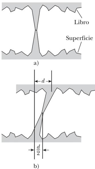
**Figura 8.7** a) Un modelo de fricción simplificado entre un libro y una superficie. Toda la fuerza de fricción se modela como aplicada a la interfaz entre dos dientes idénticos que se proyectan del libro y la superficie. b) El libro se mueve hacia la derecha una distancia  $d$ . El punto de aplicación de la fuerza de fricción se mueve a través de un desplazamiento de magnitud  $d/2$ .
