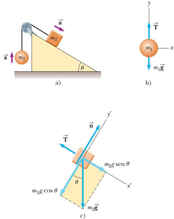
**Figura 5.15** (Ejemplo 5.10). a) Dos objetos conectados mediante una cuerda ligera sobre una polea sin fricción. b) Diagrama de cuerpo libre para la bola. c) Diagrama de cuerpo libre para el bloque. (El plano inclinado no tiene fricción.)
