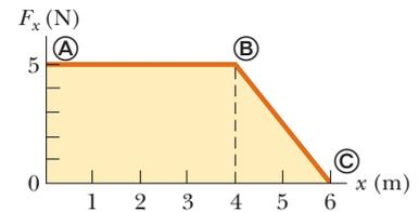
**Figura 7.8** (Ejemplo 7.4) La fuerza que actúa sobre una partícula es constante para los primeros 4.0 m de movimiento y después disminuye linealmente con  $x$  de  $x_{\text{B}} = 4.0$  m a  $x_{\text{C}} = 6.0$  m. El trabajo neto invertido por esta fuerza es el área bajo la curva.
