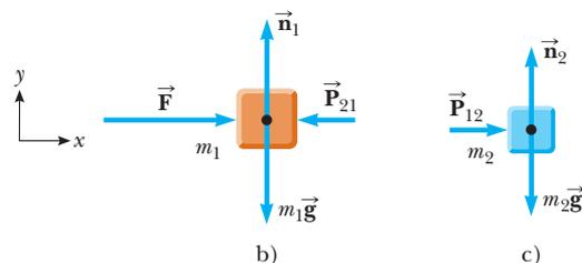
**Figura 5.12** (Ejemplo 5.7). a) Se aplica una fuerza se a un bloque de masa  $m_1$ , que empuja a un segundo bloque de masa  $m_2$ . b) Diagrama de cuerpo libre para  $m_1$ . c) Diagrama de cuerpo libre para  $m_2$ .
