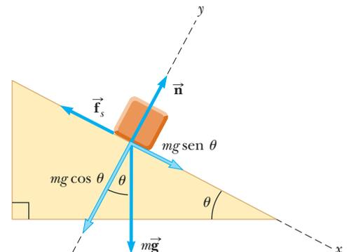
**Figura 5.18** (Ejemplo 5.11) Las fuerzas externas que se ejercen sobre un bloque que se encuentra sobre un plano inclinado rugoso son la fuerza gravitacional  $m\vec{g}$ , la fuerza normal  $\vec{n}$  y la fuerza de fricción  $\vec{f}_s$ . Por conveniencia, la fuerza gravitacional se descompone en una componente  $mg \sin \theta$  a lo largo del plano y una componente  $mg \cos \theta$  perpendicular al plano.
