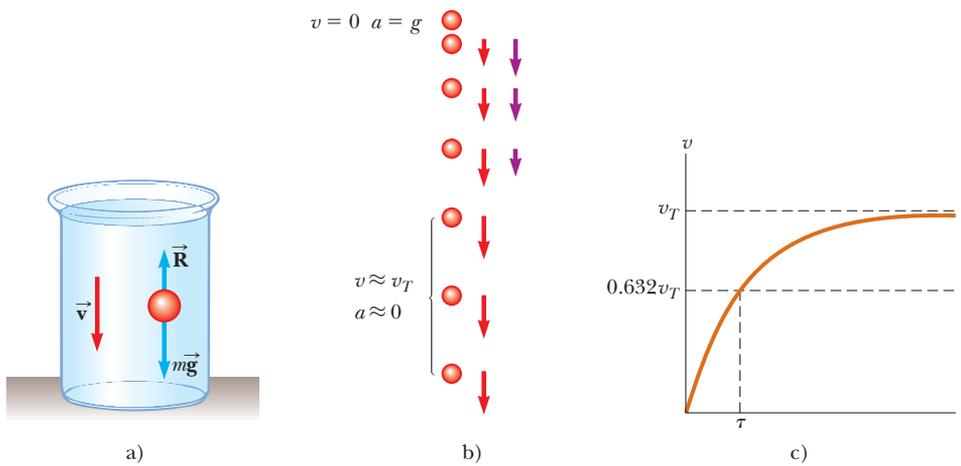
**Figura 6.13** a) Una pequeña esfera que cae a través de un líquido. b) Diagrama de movimiento de la esfera mientras cae. Se muestran los vectores velocidad (rojo) y aceleración (violeta) para cada imagen después de la primera. c) Gráfica rapidez-tiempo para la esfera. La esfera se aproxima a una rapidez máxima (o terminal)  $v_T$  y la constante de tiempo  $\tau$  es el tiempo en el que llega a una rapidez de  $0.632v_T$ .
