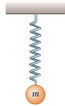
**Figura 7.17** (Pregunta rápida 7.7) Una bola conectada a un resorte sin masa suspendido verticalmente. ¿Qué formas de energía potencial se asocian con el sistema cuando la bola se desplaza hacia abajo?
