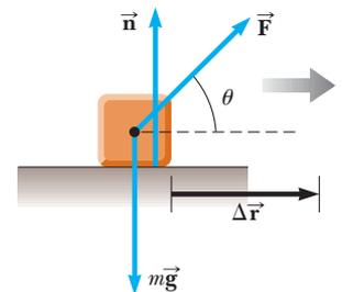
**Figura 7.3** Un objeto se desplaza sobre una superficie horizontal sin fricción. La fuerza normal  $\vec{n}$  y la fuerza gravitacional  $m\vec{g}$  no trabajan sobre el objeto. En la situación que se muestra aquí,  $\vec{F}$  es la única fuerza que realiza trabajo sobre el objeto.
