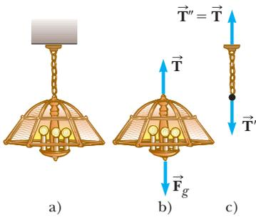
**Figura 5.7** a) Una lámpara suspendida del techo mediante una cadena de masa despreciable. b) Las fuerzas que actúan sobre la lámpara son la fuerza gravitacional  $\vec{F}_g$  y la fuerza  $\vec{T}$  que ejerce la cadena. c) Las fuerzas que actúan sobre la cadena son la fuerza  $\vec{T}'$  que ejerce la lámpara y la fuerza  $\vec{T}''$  que ejerce el techo.
