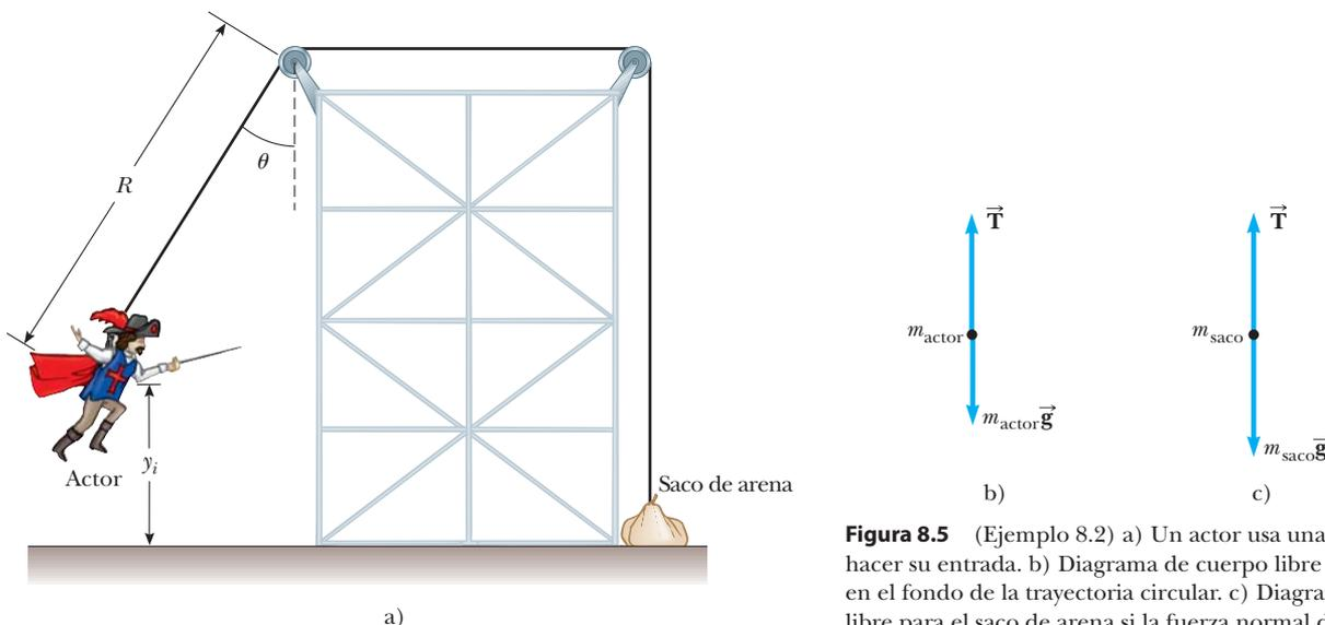
**Figura 8.5** (Ejemplo 8.2) a) Un actor usa una armazón para hacer su entrada. b) Diagrama de cuerpo libre para el actor en el fondo de la trayectoria circular. c) Diagrama de cuerpo libre para el saco de arena si la fuerza normal desde el suelo tiende a cero.
