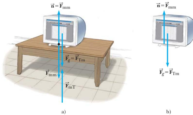
**Figura 5.6** a) Cuando un monitor de computadora está en reposo sobre una mesa, las fuerzas que actúan sobre el monitor son la fuerza normal  $\vec{n}$  y la fuerza gravitacional  $\vec{F}_g$ . La reacción a  $\vec{n}$  es la fuerza  $\vec{F}_{mm}$  que ejerce el monitor sobre la mesa. La reacción a  $\vec{F}_g$  es la fuerza  $\vec{F}_{mT}$  que ejerce el monitor sobre la Tierra. b) Diagrama de cuerpo libre para el monitor.
