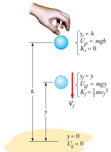
**Figura 8.4** (Ejemplo 8.1) Una bola se deja caer desde una altura  $h$  sobre el suelo. Al inicio, la energía total del sistema bola-Tierra es energía potencial gravitacional, igual a  $mgh$  en relación con el suelo. En la elevación  $y$ , la energía total es la suma de las energías cinética y potencial.
