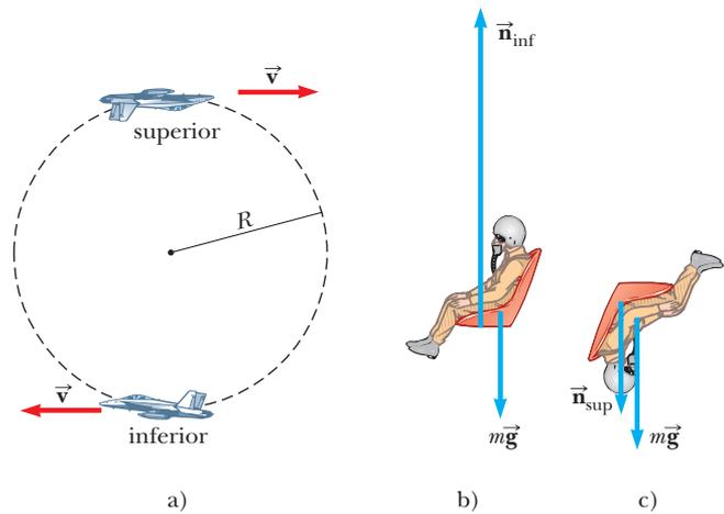
**Figura 6.6** (Ejemplo 6.5) a) Un avión ejecuta un rizo mientras se mueve en un círculo vertical con rapidez constante. b) Diagrama de cuerpo libre del piloto en la parte inferior del rizo. En esta posición, el piloto experimenta un peso aparente mayor que su peso verdadero. c) Diagrama de cuerpo libre para el piloto en la parte superior del rizo.
