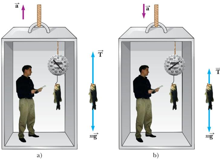
**Figura 5.13** (Ejemplo 5.8) Peso aparente contra peso real. a) Cuando el elevador acelera hacia arriba, la lectura en la balanza de resorte proporciona un valor mayor que el peso del pescado. b) Cuando el elevador acelera hacia abajo, la lectura en la balanza de resorte proporciona un valor menor que el peso del pescado.
