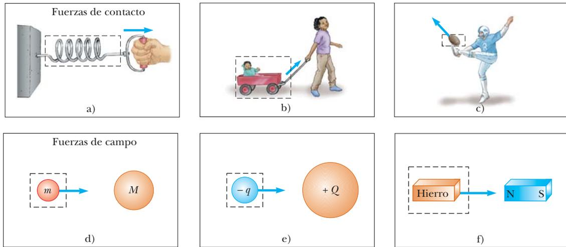
**Figura 5.1** Algunos ejemplos de fuerzas aplicadas. En cada caso, sobre el objeto dentro del área limitada por líneas discontinuas se ejerce una fuerza. Algún agente en el ambiente exterior al área del recuadro ejerce una fuerza sobre el objeto.
