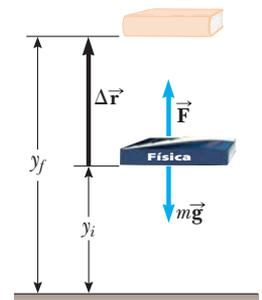
**Figura 7.15** El trabajo invertido por un agente externo en el sistema del libro y la Tierra a medida que el libro se levanta lentamente desde una altura  $y_i$  a una altura  $y_f$  es igual a  $mgy_f - mgy_i$ .
