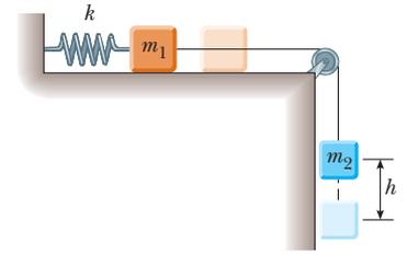
**Figura 8.12** (Ejemplo 8.9) A medida que el bloque colgante se mueve desde su elevación más alta hacia la más baja, el sistema pierde energía potencial gravitacional pero gana energía potencial elástica en el resorte. Parte de la energía mecánica se transforma a energía interna debido a fricción entre el bloque deslizando y la superficie.
