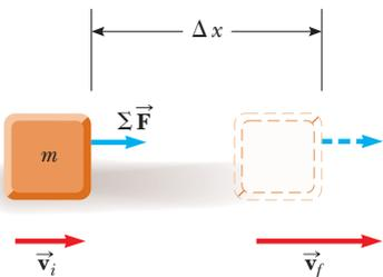
**Figura 7.12** Un objeto que se somete a un desplazamiento  $\Delta \vec{\mathbf{r}} = \Delta x \hat{\mathbf{i}}$  y un cambio en velocidad bajo la acción de una fuerza neta constante  $\Sigma \vec{\mathbf{F}}$ .
