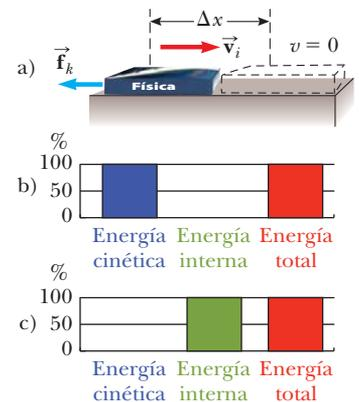
**Figura 7.18** a) Un libro que se desliza hacia la derecha sobre una superficie horizontal frena en presencia de una fuerza de fricción cinética que actúa hacia la izquierda. b) Gráfica de barras de energía que muestra la energía en el sistema del libro y la superficie en el instante de tiempo inicial. La energía del sistema es toda energía cinética. c) Después de que el libro se detiene, la energía del sistema es toda energía interna.
